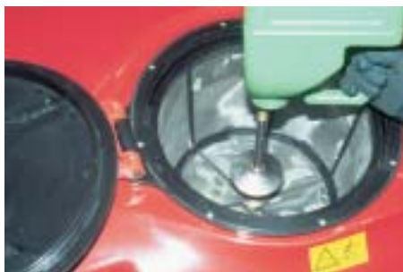
Kanisterspülung am Sprüngerät (Reinigungsdüse im Einfüll-dom eingebaut)
