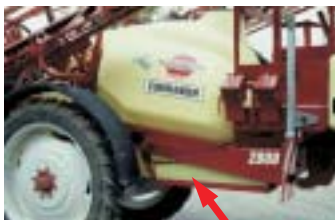
Zusatzwassertank am Feldspritzgerät
