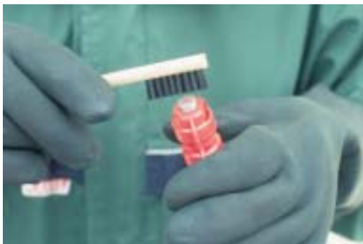
Düsenreinigung: Reinigung nur mit weicher Bürste
