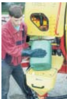
Kanisterspülung bei Feldspritzgerät (Reinigungsdüse in Einfüllschleuse eingebaut)
